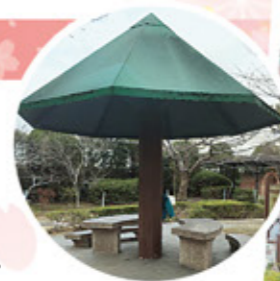
▲下水汚泥をリサイクルしたベンチとテーブルがあります。溶融スラグ(下水汚泥を高温で溶岩状にし、冷却したもので作られています)。
