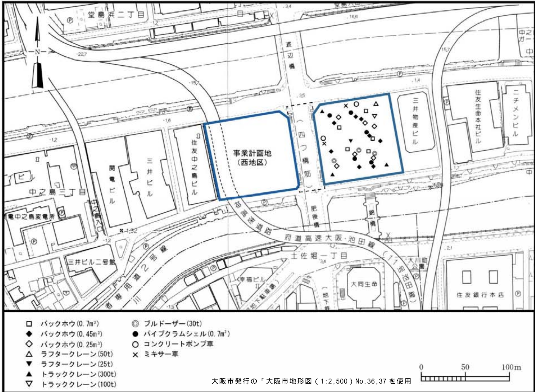
図 5-5-13(1) 騒音源配置図 (東地区工事最盛期)
