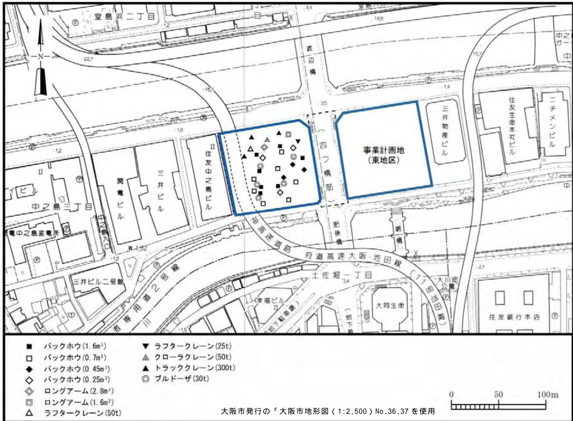
図 5-6-6(2) 振動源配置図(西地区工事最盛期)
