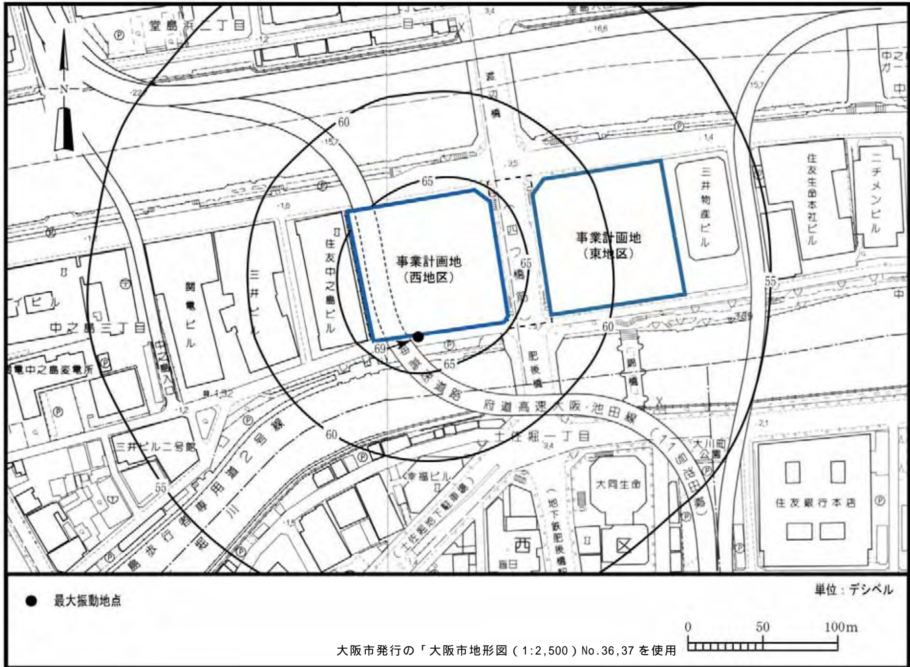
図 5-6-7(2) 建設機械振動予測結果(西地区工事最盛期)
