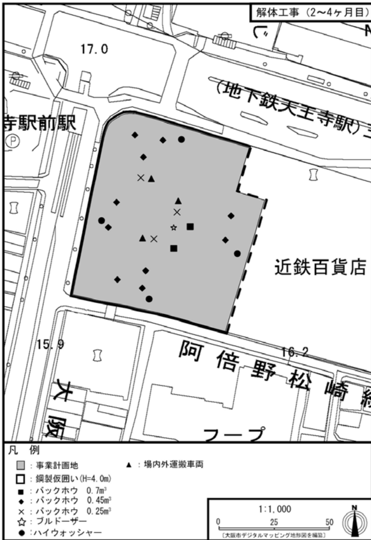
図 5.3.8 騒音源配置図(解体工事2~4ヶ月目 昼間)
