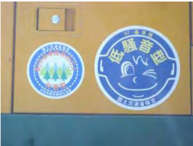
写真1：建設機械低騒音型、排出ガス対策型表示
