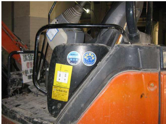
写真3 排出ガス基準適合建設機械
