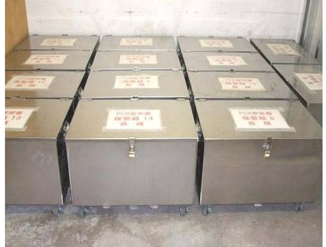
写真 17 PCB 室内保管箱設置状況
