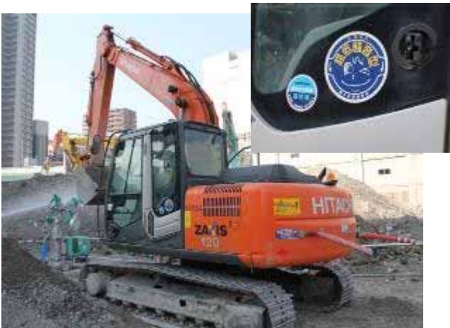
写真3 環境配慮型建設機械の使用 (排ガス基準適合車、低騒音型)
