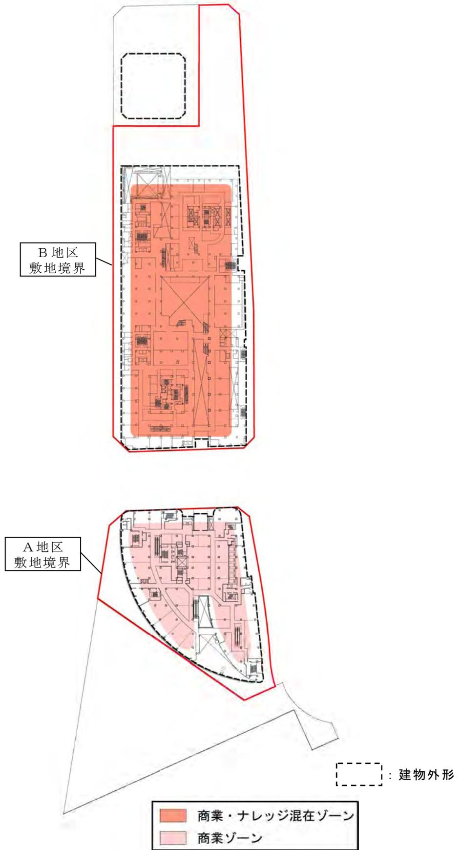
図 1-3(7) 主要階平面図 (5階：中層棟中間階)
