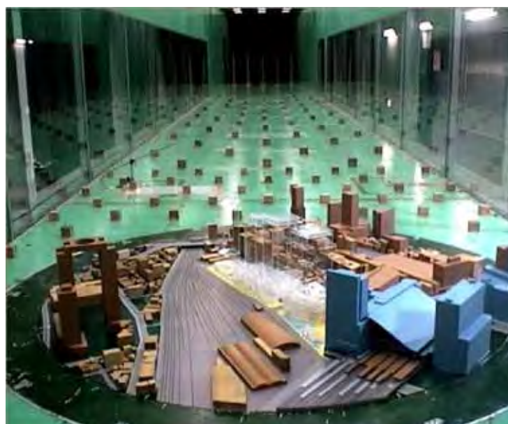
図 5-11-6 風洞内の模型設置状況
