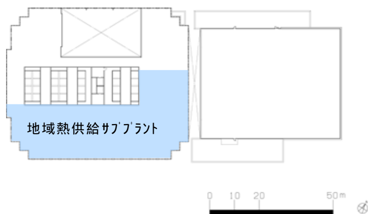
図 1-8 地域熱供給サブプラントスペース（8 階）
