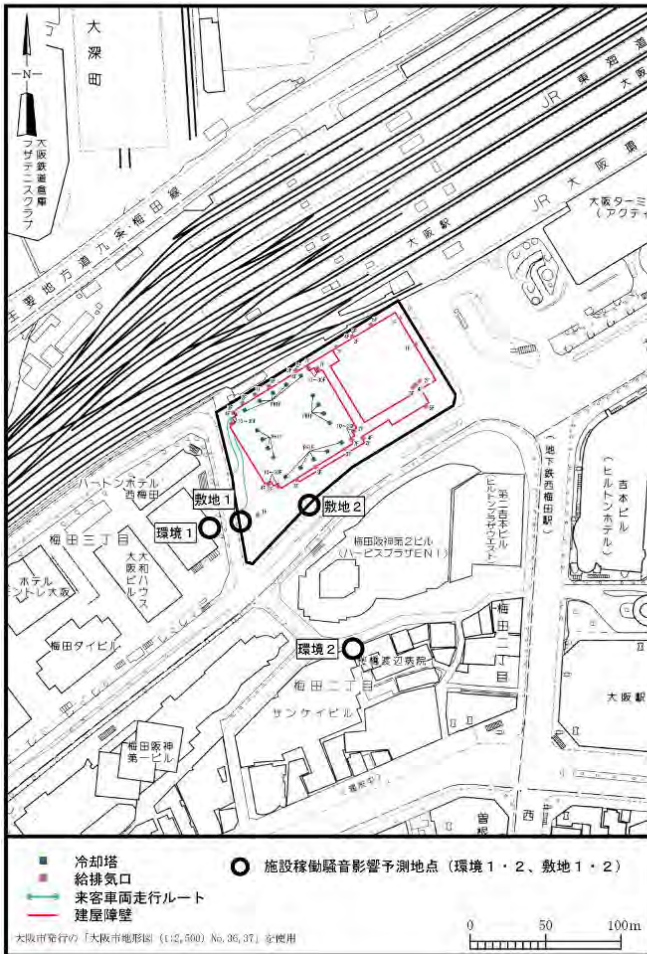
図 5-4-8 騒音源及び障壁配置図(施設供用後)
