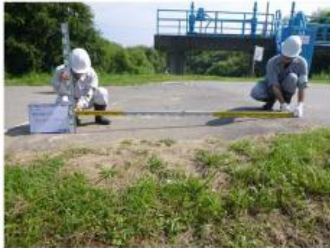
図 6.3.7 構造物周辺の抜け上がり計測イメージ
