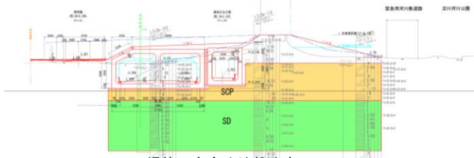
堤体下も含め地盤改良
