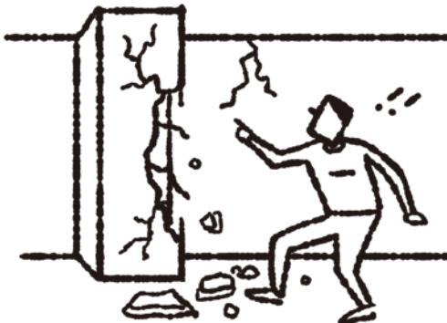
建物が傾いたり、コンクリートの柱や梁にひび割れが入って鉄筋が見える場合は避難を優先してください。
