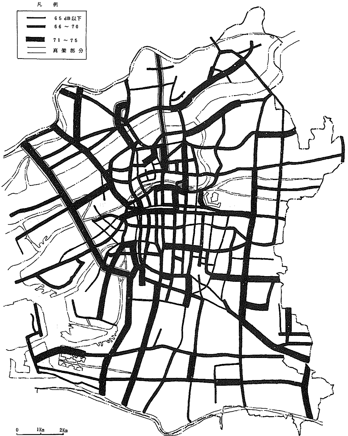
図 3 - 10 幹線道路の線路別騒音レベル (昭和52年度)
