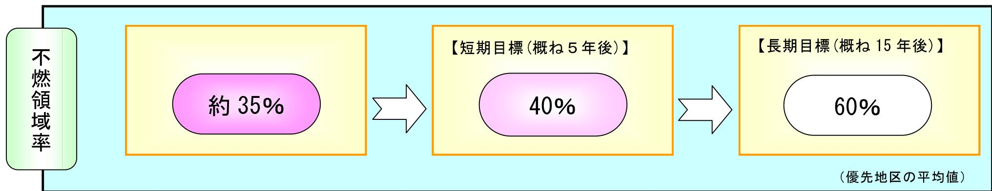
※不燃領域率：まちの燃えにくさを示す指標で、不燃領域率が30%程度以下の市街地では、大規模な地震などで出火すれば、その市街地の焼失率は80%を超える、極めて危険な状態にあるといえる。また、不燃領域率が40%以上の水準に達すると焼失率は急激に低下し20～25%程度となる。さらに、不燃領域率が60～70%を超えると、市街地の焼失率はほとんどゼロとなり、延焼の危険性は無くなるものと判断できる。
