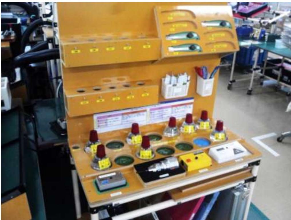
工具ごとに分けて、きちんと整理されています。しかも、シールを貼ってあるだけでなく、どのような工具かでわかるように、形が工夫されています。
