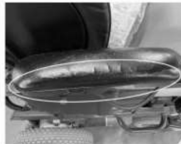
⑦アームサポート変形 推測される原因：通常劣化による変形
