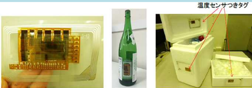
写真：印刷できる商用ICカード規格スピードの温度センサつき高速デジタル回路（左）と、温度センシング機能を搭載した電子タグの利用例（中、右）
