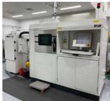
①金属粉末積層造形装置
