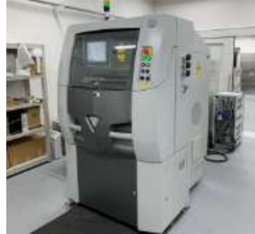
②微粉末積層造形装置
