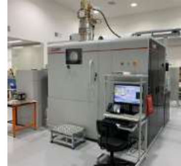
③電子ビーム積層造形装置
