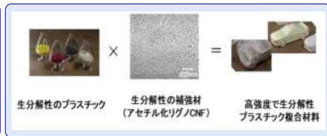
強度不足が弱点の生分解性プラスチック（自然界の微生物で分解可能）の用途を広げる高強度化の技術例（出典：国立研究開発法人産業技術総合研究所）
