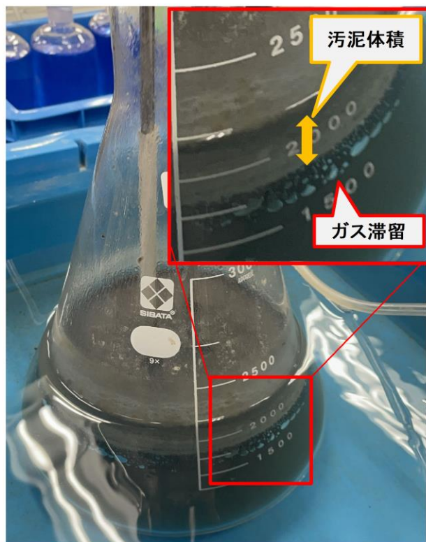
写真2 ガス滞留状況
