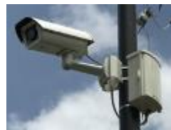
定点カメラで現場状況を遠隔で確認
