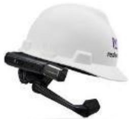
ウェアラブルカメラを活用して現場の状況をリアルタイム共有
