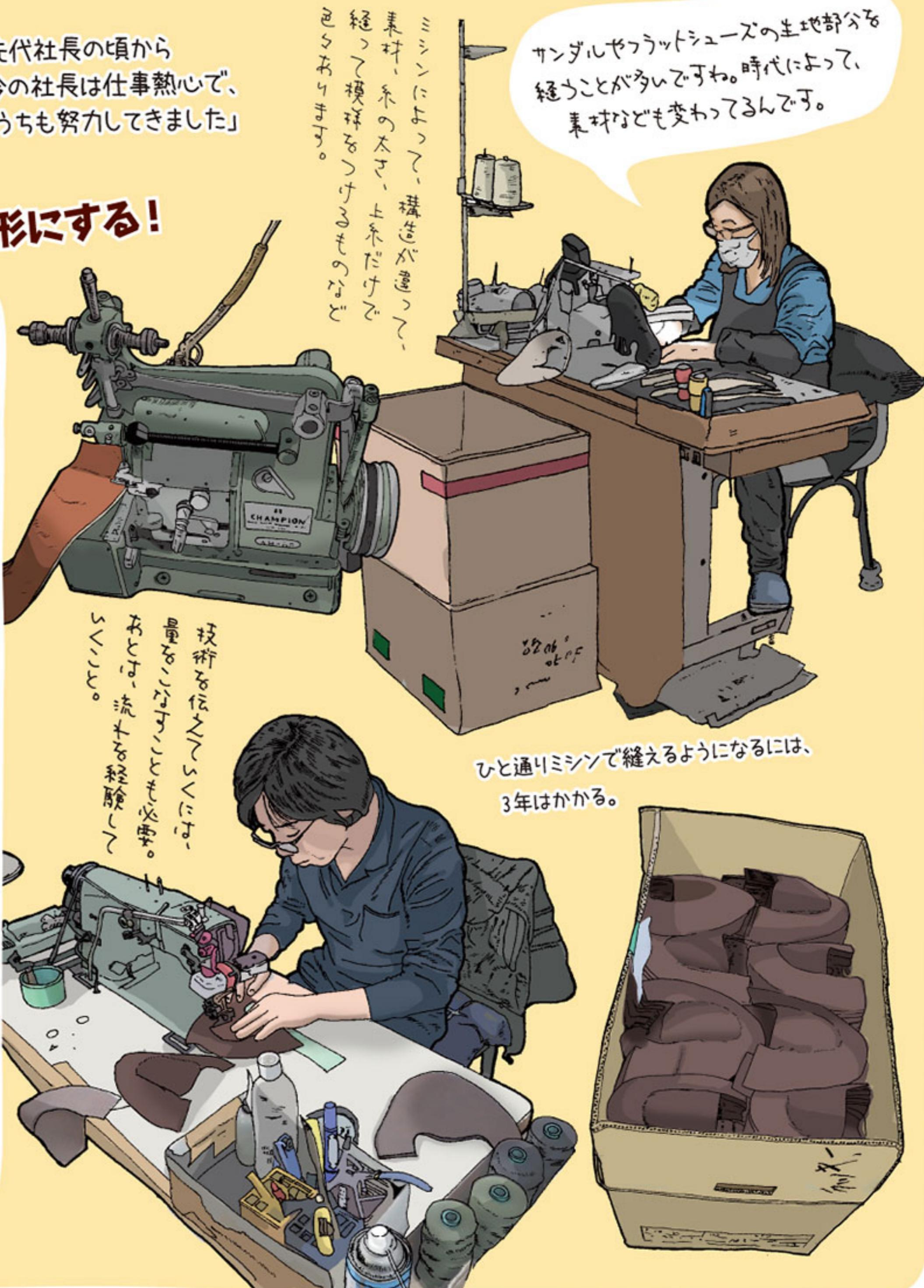
凹凸のあるものもミシンで縫えるよう、加工する形状にあわせて、ミシンの生地通り、上手に之を加工して縫えるように工夫する。
