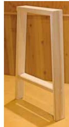
仕口・継手で作る家具製作技能士2級の実技試験課題
