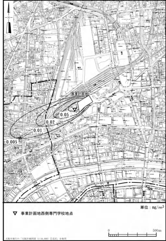
図 2 - 5 建設機械等の稼働による浮遊粒子状物質 1 時間値寄与濃度（西側専門学校）
