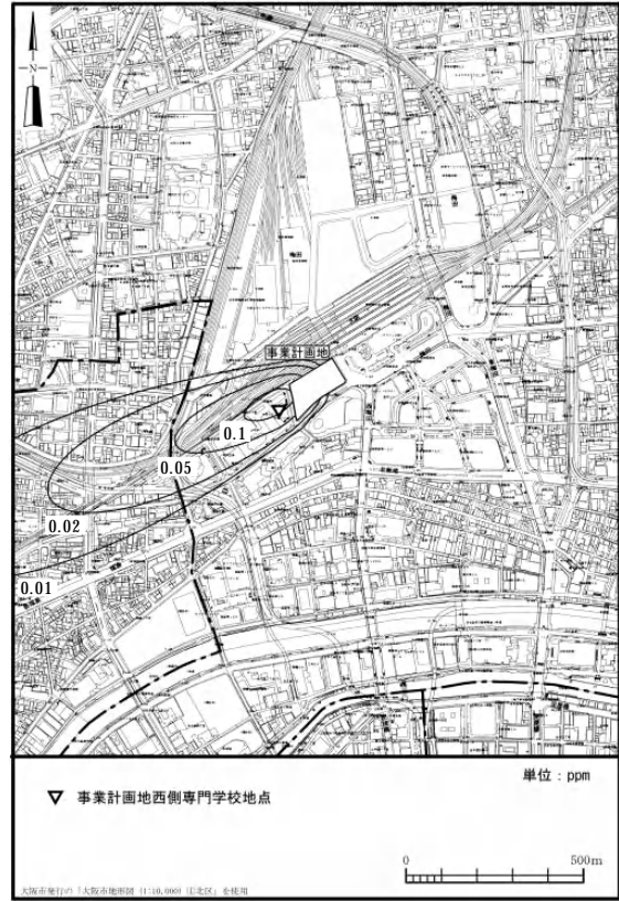
図 2 - 3 建設機械等の稼働による二酸化窒素 1 時間値寄与濃度（西側専門学校）
