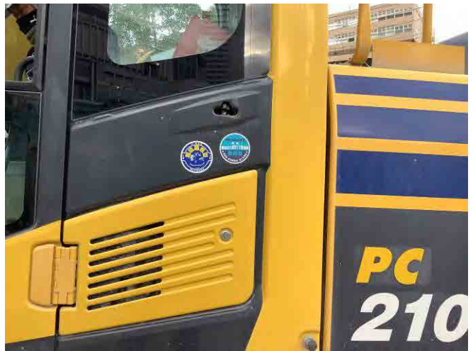
写真4 排出ガス基準適合・低騒音型建設機械
