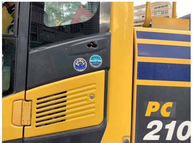
写真6 排出ガス基準適合・低騒音型建設機械
