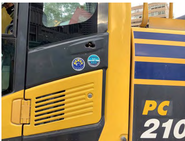
写真6 排出ガス基準適合・低騒音型建設機械
