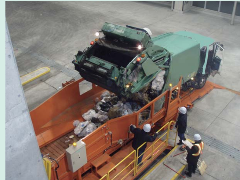
①焼却工場にて、搬入する収集業者に対して、搬入物検査を実施しています。（コンベア上にごみを展開している様子）
