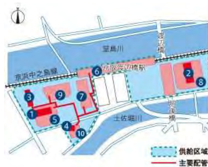
図 2 - 16 河川水を利用した地域熱供給(中之島 3 丁目地区)
