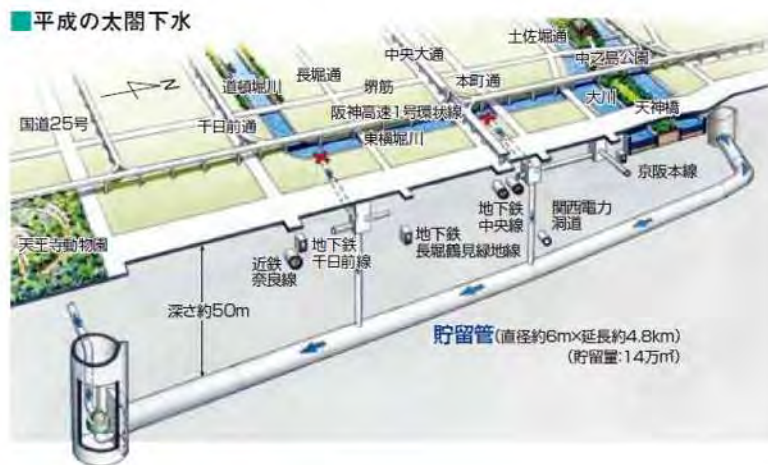
図3 - 9 平成の太閤下水 (北浜逢阪貯留管)
