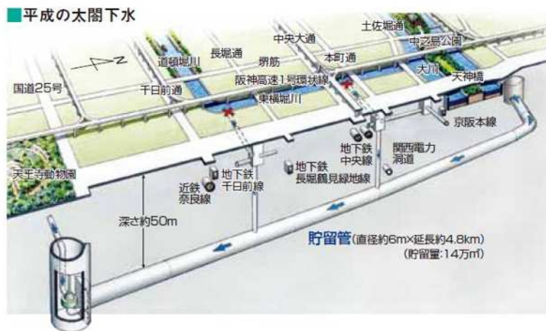
図3 - 9 平成の太閤下水（北浜逢阪貯留管）
