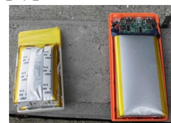
膨張・変形した小型充電式電池
