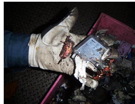
火災の原因となったリチウムイオン電池
