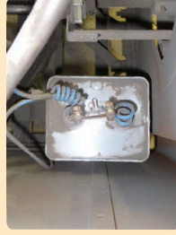
電気溶接機の内部に取り付けられた 低圧コンデンサー
