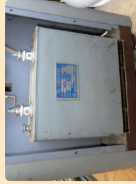
電気溶接機の側面に取り付けられた 低圧コンデンサー
