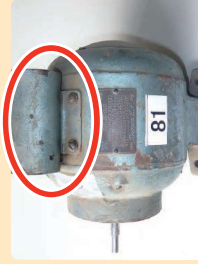
単相モーターに取り付けられた 低圧コンデンサー
