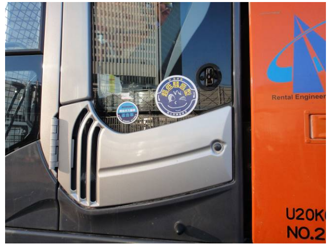
写真2 建設機械低騒音型・排出ガス対策型表示
