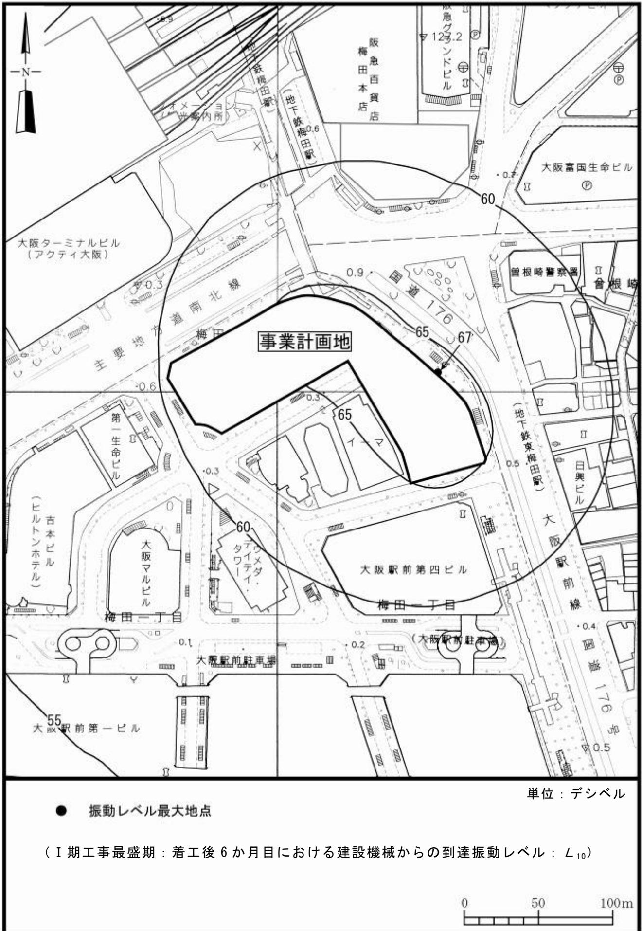
図 5-5-7(1) 建設機械振動予測結果 (I 期工事最盛期)
