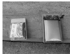
膨張・変形した電池
