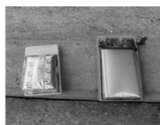
膨張・変形した電池
