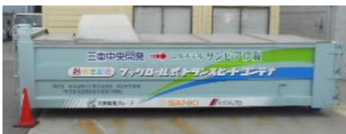
蓄熱タンクをコンテナ方式で利用施設に供給（コンテナ全景）
