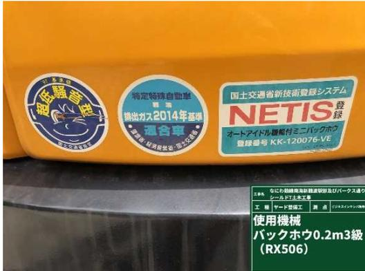
写真 8.1 排出ガス対策型及び低騒音型機械
