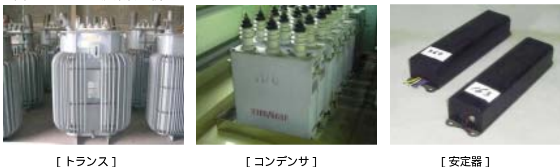
図 2 PCB廃棄物の例
