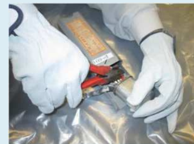
PCB含有のコンデンサ部分を取り外すことができる廃安定器の取り外し作業
