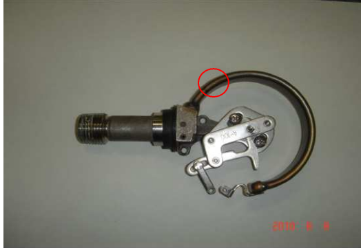
【亀裂はブルドン管基部の赤丸部分】
