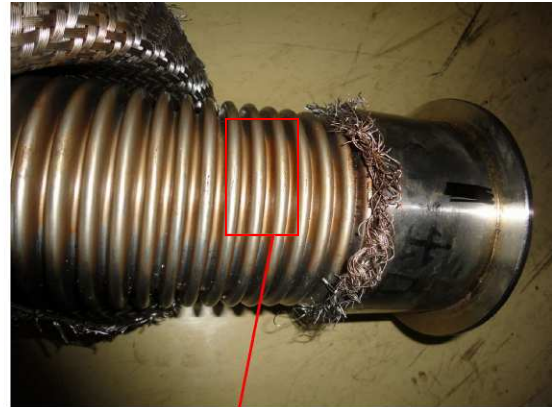
フレキシブルホースのブレード除去
