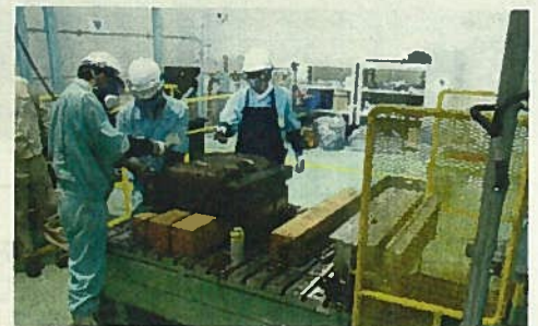
払出設備のトランスのコア処理(引渡性能試験) (真空加熱分離装置で処理済のコア切断)
