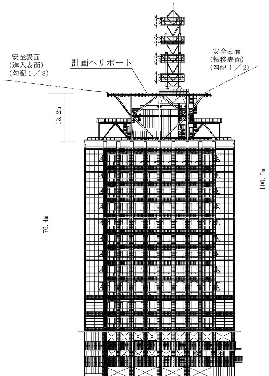
図 2.5.3 計画ヘリポート設置建築物の北側立面図
