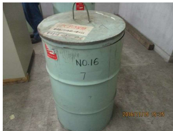
ドラム缶に入れコンクリート固化
